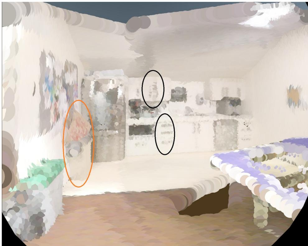
図 19: 提案レンダリング手法による視認性向上の例: 間引いた点群データ ( $r=3$ )
