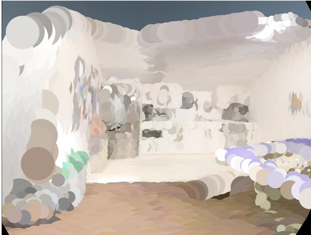
図 16: 未補正レンダリングの実行結果: 間引いた点群データ ( $r=5$ )
